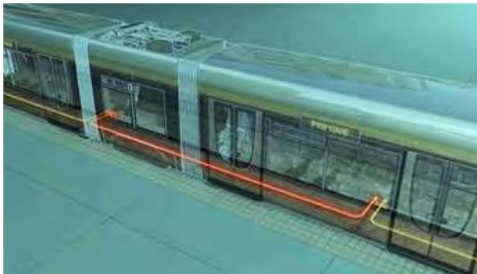
Figure : circuit primaire d'alimentation PRIMOVE (enfoui dans le sol)
