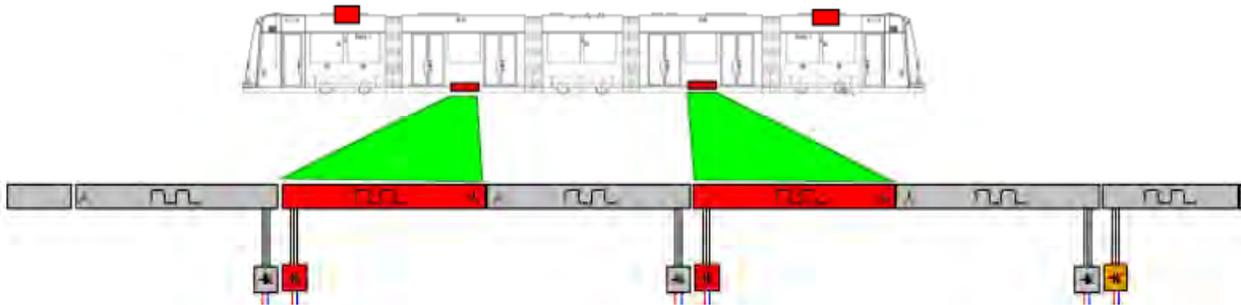
Figure : principe général du système PRIMOVE
