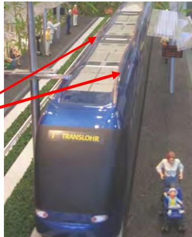
Figure : principe WIPOST de la piste d'alimentation en toiture
